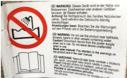
Heutzutage übliches Sicherheitslabel am Stromkabel eines Föns
