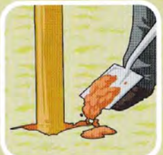
Löcher auffüllen; Erde festdrücken.
