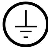
8. ➔ Potentialausgleichsleitung in den zugehörigen Anschluss am Abfüllventil stecken.
