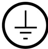
Nach der Installation gemäß [Kapitel 6.4 „Mechanische Installation“ auf Seite 62](#) sind alle Baugruppen der Abfüllmaschine gekoppelt an die örtliche Potentialausgleichsschiene angeschlossen, um Zündfunken und Berührungsspannungen im Fehlerfall zu verhindern.
