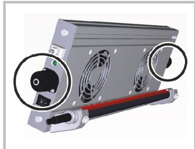
7. Das HS-Kabel des Ionisationsstabs und die Signalleitung K8 in Bögen ( $r = > 50 \text{ mm}$ ) bis zum gewünschten Einsatzort des Entladenetzteils verlegen.
