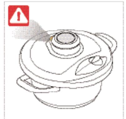
Bei folgenden Speisen darf die Schnellgareinheit **nicht mit dem gelben Abdampfkopf** drucklos gemacht werden, sondern nur durch Abkühlen mit kaltem Wasser oder durch Stehenlassen. Es könnte heißes Kochgut austreten, Verbrühungsgefahr. Zudem können die Ventile des Secuquick softline zu stark verschmutzen.
